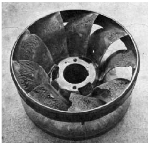
Roue de turbine Francis érodée par cavitation
