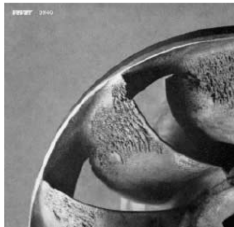
Plages érodées par cavitation sur l'extrados de l'aubage d'une roue Francis
