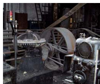
Système de renvoi d'angle Notez taille de la poulie motrice, et, au 1 er plan, le régulateur de vitesse de la turbine
